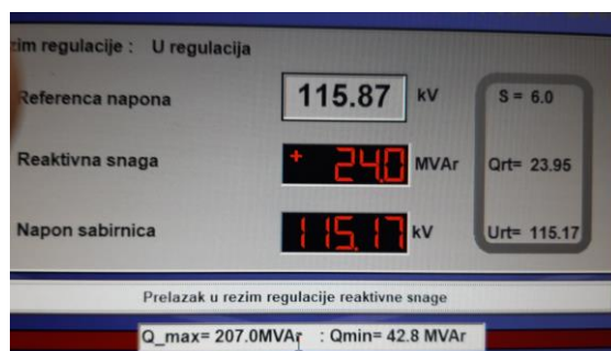
SLIKA 8 PROZOR ZA ZADAVANJE REFERENCE NAPONA I OČITAVANJE DOPUŠTENOG OPSEGA REAKTIVNIH SNAGA U TAČKI PRIKLJUČENJA
