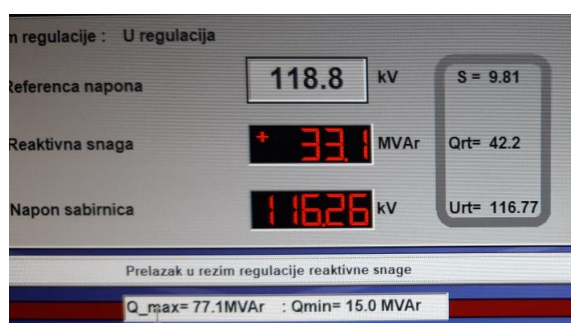
SLIKA 11 PROZOR ZA ZADAVANJE REFERENCE NAPONA I OČITAVANJE DOPUŠTENOG OPSEGA REAKTIVNIH SNAGA U TAČKI PRIKLJUČENJA
